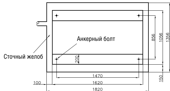
Чертеж, содержащий монтажные размеры модуля Рис. 3-3
